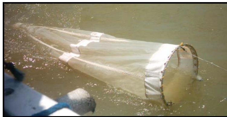
FIGURA 3 - Arrasto superficial da rede de ictioplâncton utilizada nas amostragens.
