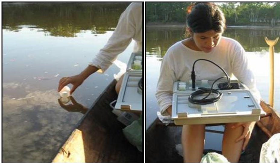
FIGURA 2: Determinação in situ no momento da despesca de dados abióticos, com o auxílio de um multianalisador.
