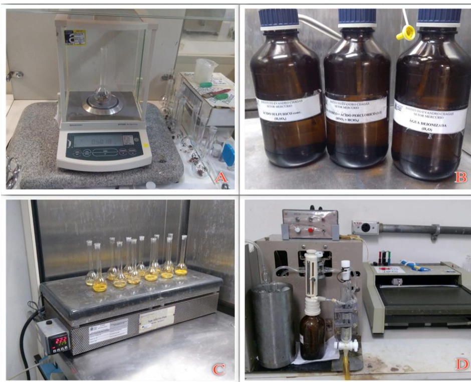
Fig. 4. Análise de mercúrio total por Espectrometria de Absorção Atômica com Geração de Vapor Frio (CVAAS).
