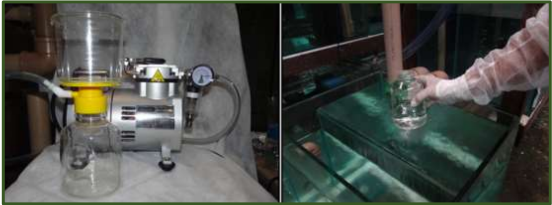
Figura 4 – A esquerda, Sistema de filtração do tipo Stericup acoplado a bomba a vácuo. A direita, cisterna de armazenamento de água utilizada para coleta de amostras de eDNA.
